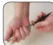
2. Pousser entièrement le tube FuelFlex sur le raccord.
